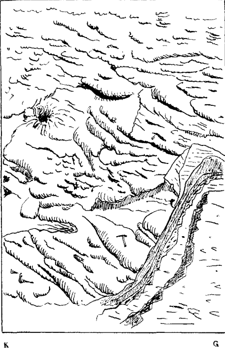
Şekil 3: Yarı plastik tabaka kayması. Devrik tabakaların erozyonla aşınmış olan tabanlarında kaymadan ötürü oluşan bükümler üs boyutlu olarak görülmektedir. Kayma yönü resimde üstten alta doğru (güneydoğudan kuzeybatıya) yönelmiştir. Kırıkkale kuzeybatısı, Kızılırmak ile demiryolu arasında yarma.
